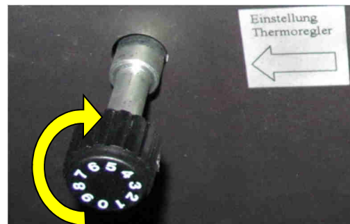
Abb. 19: Thermoregler auf Grundeinstellung
