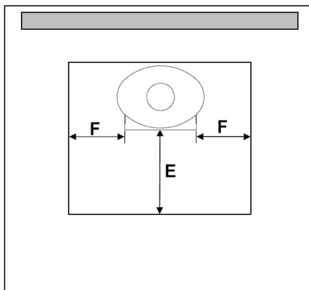
Abb. 4: Funkenschutzvorlage K140A
